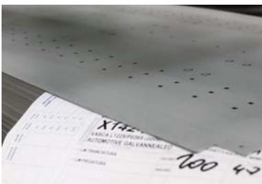
Galvannealed Blech ist eine Variante von feuerverzinktem Blech. Das Produkt unterliegt einem Feuerbeschichtungsprozess und wird bis ca. 550 °C erhitzt. Dies ermöglicht es dem Zink mit dem Stahlblech eine Legierung einzugehen.
